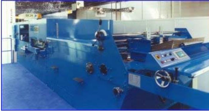
**Abbildung 2** Computergesteuerte Stanze
