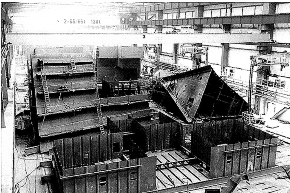
Abbildung: Zusammenbau der Sektionen in einer Halle
