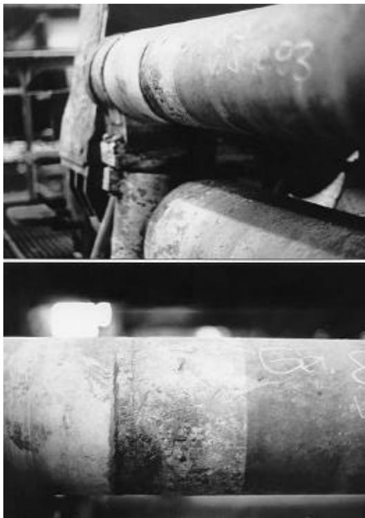
Abbildung 4: Eine defekte Stranggießrolle
