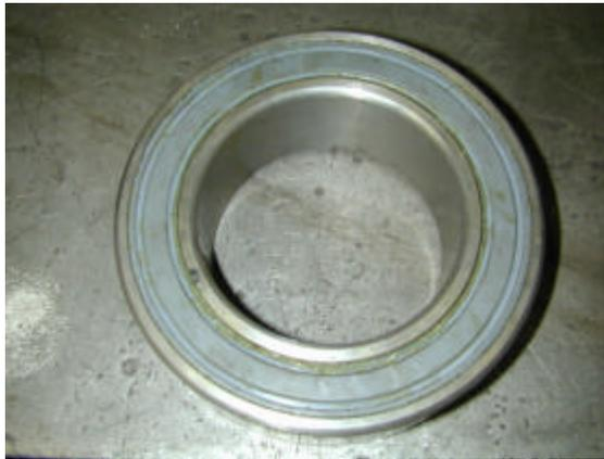
Pendelrollenlager d= 110mm, D= 180mm, Bild 2
